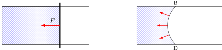
FIGURE 6.1 – A gauche, force de tension superficielle sur un barreau mobile. A droite, fil tendu par les forces de tension superficielle.
